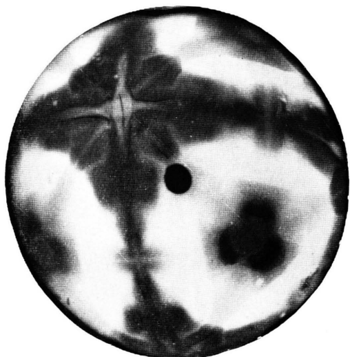
Abb. 3. Oxydation einer Ni-Einkristallkugel bei 800 °C und 1 Atm. O_2 . a) Lageskizze, b) nach 2 min Oxydationszeit, c) nach 5 min, d) nach 15 min.
